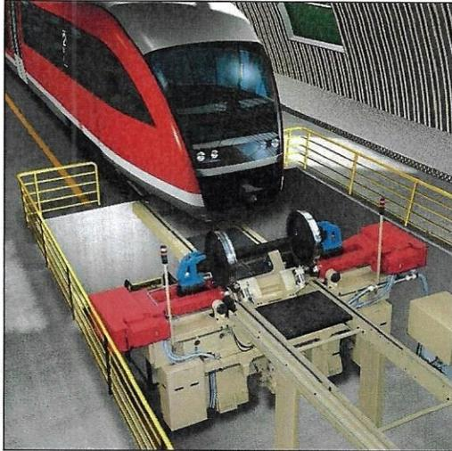
**Abbildung 15** Beispiel einer Unterflur-Radsatzdrehmaschine (Fabr. Hegenscheidt)
